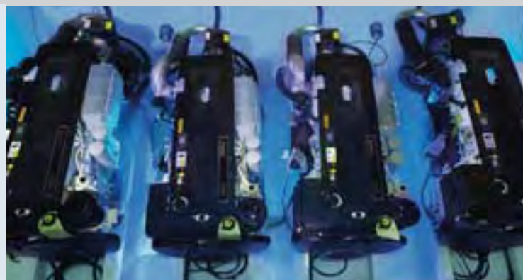
Instalación de Volvo Penta IPS600 con cuatro motores.
